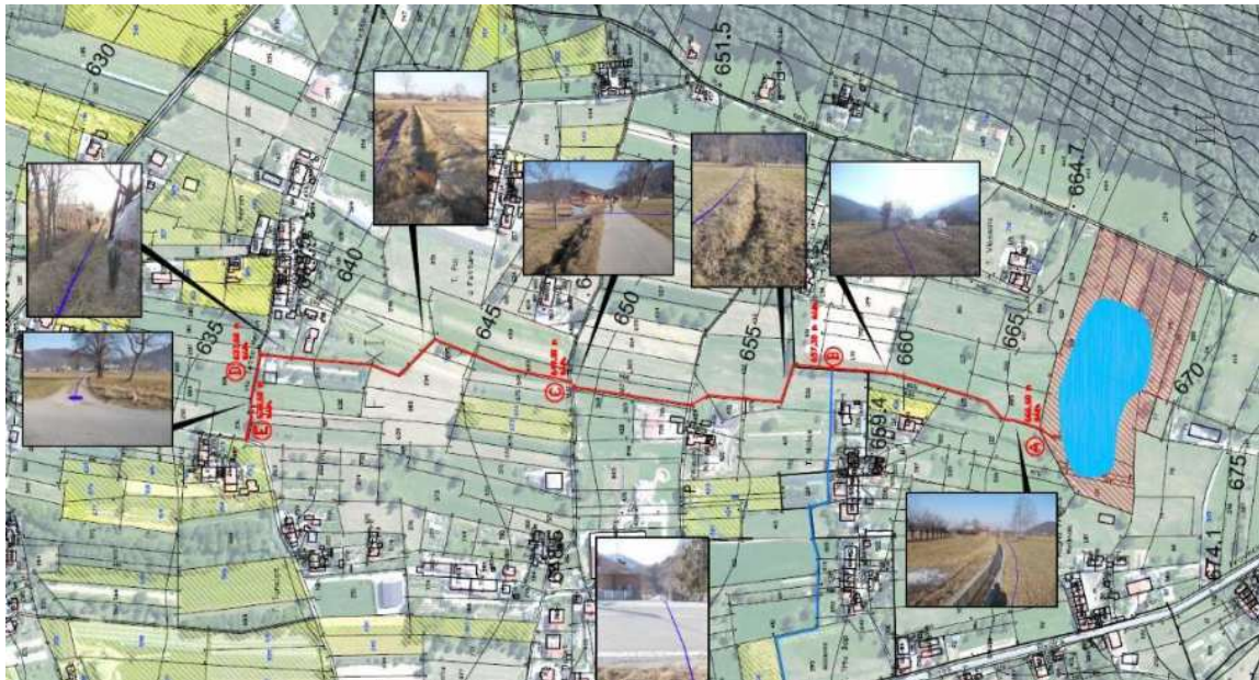
Fig. 3. Planimetria del primo tratto di condotta principale (punti A-E). Fonte: progetto esecutivo, studio ing. Ferrari.
