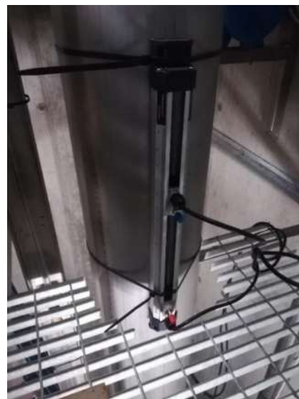
Fig. 11. Misuratori di portata a ultrasuoni utilizzati per la misura sulle condotte in pressione.
