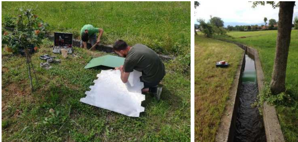
Fig. 9. Preparazione dei risalti idraulici per la misurazione delle portate nel Bedale Rivoira Soprana.
