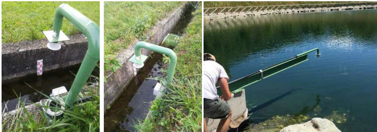
Fig. 7. Misuratori di livello a ultrasuoni installato nel Bedale Rivoira Soprana a monte (a sx) e a valle (al centro) della presa dell'invaso, e nei pressi dello scarico di troppo pieno del lago (a dx).
