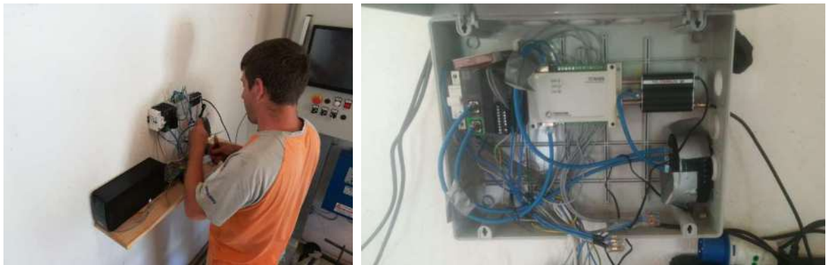
Fig. 13. À gauche : installation du système d'enregistrement et de transmission des données ; à droite : boîtier électrique contenant le système composé d'un ordinateur Modbus, d'un contrôleur Ethernet, d'un modem GPRS et d'un commutateur Ethernet.
