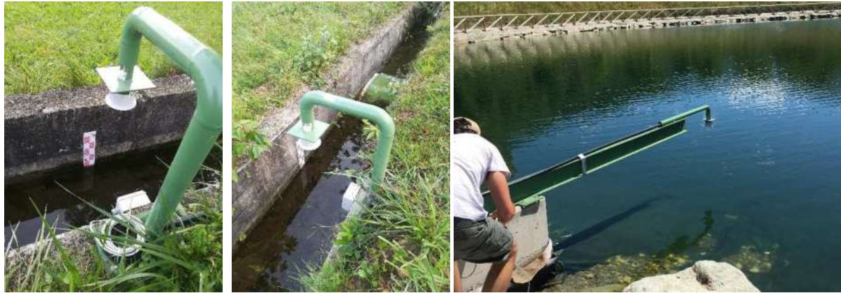
Fig. 7. Jauges de niveau à ultrasons installées dans le Bedale Rivoira Soprana de Bedale en amont (à gauche) et en aval (au centre) de la prise d'eau du réservoir, et près de la sortie du trop-plein du lac (à droite).
