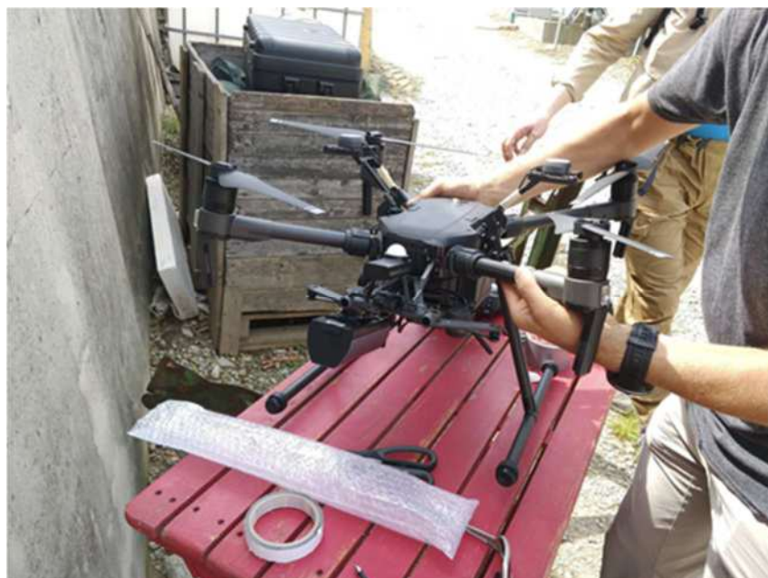
Fig. 29. Installation de la caméra Slanrange 4P+ sur le système DJI Matrice 200.
