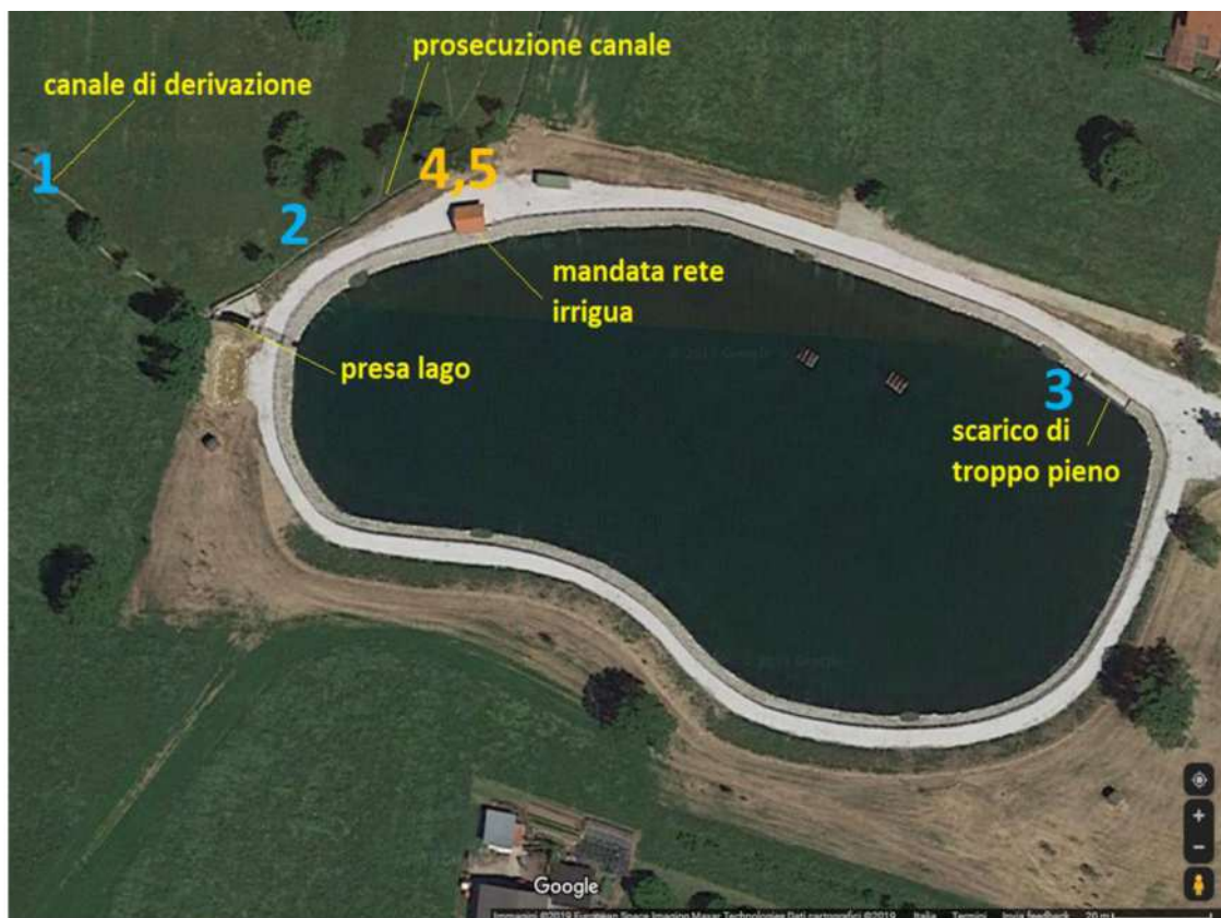
Fig. 6. Planimetria dell'invaso di Rivoira con il canale Bedale Rivoira Soprana dal quale deriva l'invaso, lo scarico di troppo pieno e l'edificio di mandata della rete irrigua.
