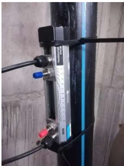
Fig. 11. Misuratori di portata a ultrasuoni utilizzati per la misura sulle condotte in pressione.
