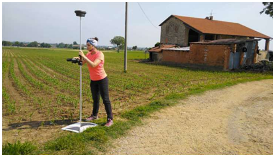
Fig. 30. Mesure des marqueurs avec l'approche GNSS RTK.
