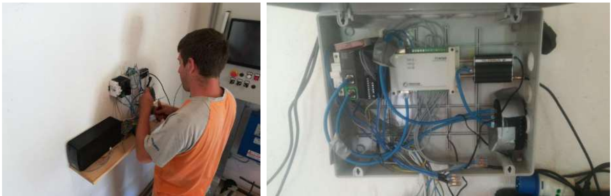
Fig. 13. Sulla sx: installazione del sistema di registrazione e trasmissione dati; sulla dx: scatola elettrica contenente il sistema composto da calcolatore Modbus, controller ethernet, modem GRPS e switch ethernet.
