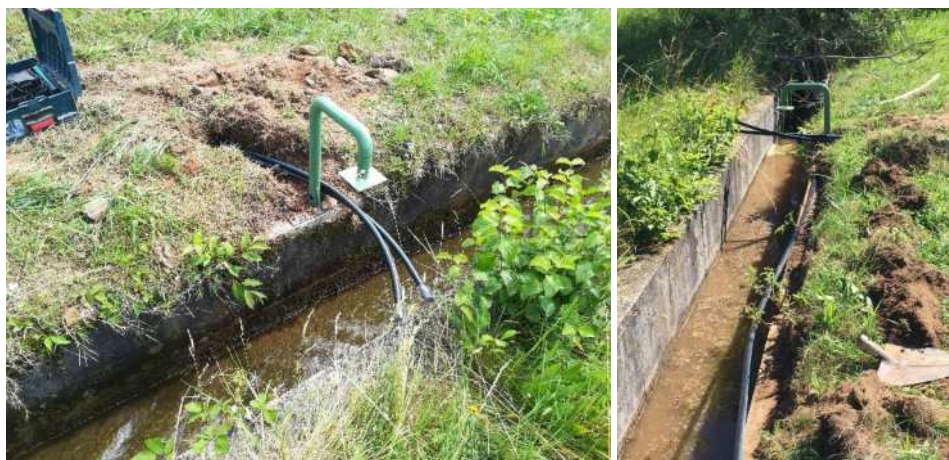
Fig. 10. Cablatura dei misuratori di livello nel punto 2.
