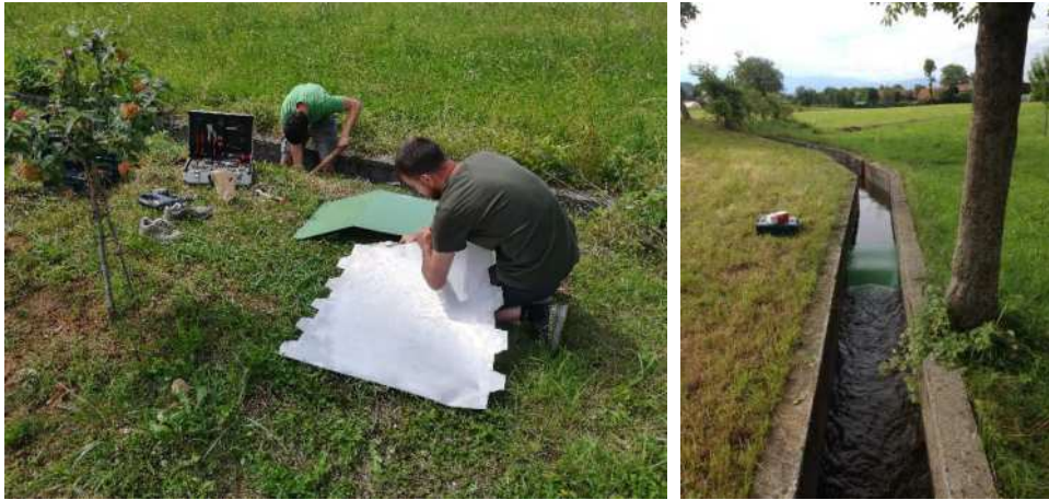
Fig. 9. Préparation des colonnes montantes hydrauliques pour la mesure du débit dans le Bedale Rivoira Soprana.
